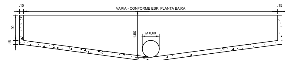
DETALHAMENTO TRINCHEIRA DRENANTE EM CONCRETO ARMADO
